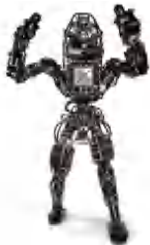
图、波士顿动力的Atlas使用液压驱动，运动性能优越
