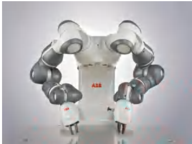
图、ABB双臂协作机器人的自由度为14个，市场上仅此一款
